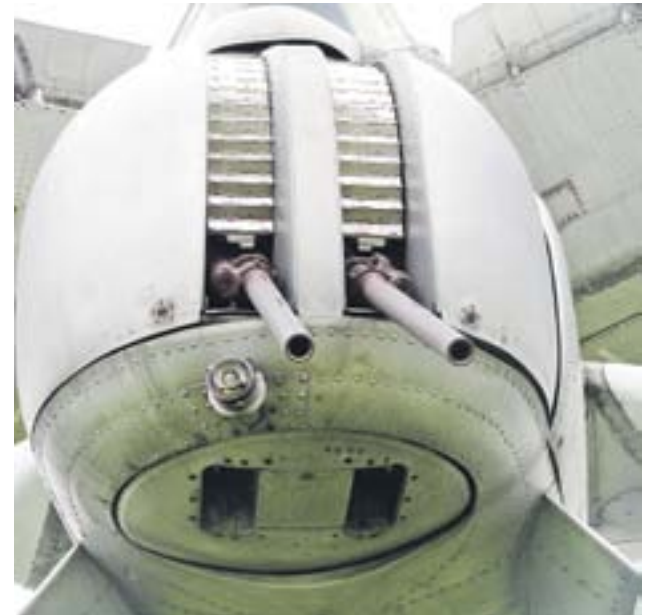
Пушки АМ-23 в кормовой установке самолета Ту-142. Фото авиару.рф
